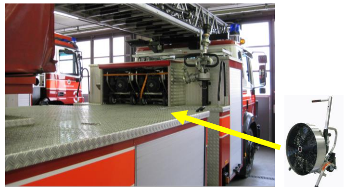
Standort der neuen zwei Lüfter auf der ADL G4.
