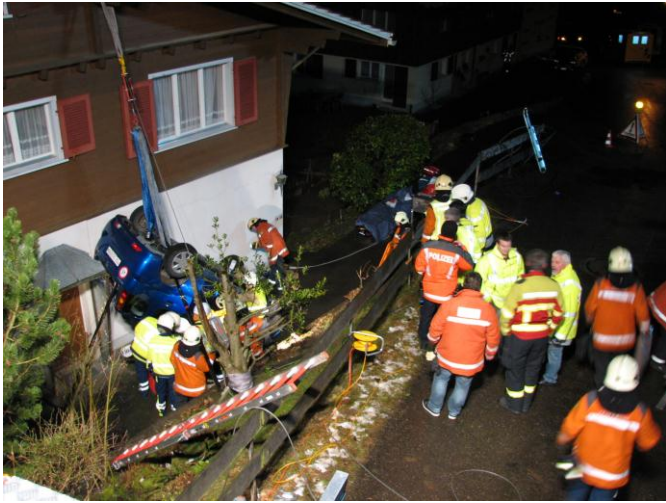
Fahrzeugsicherung via Dachbalken mit einer Umlenkrolle
