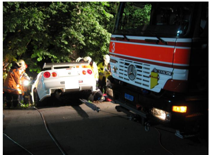
Fahrzeugsicherung mit der Seilwinde
